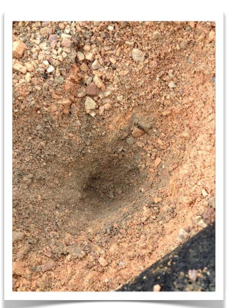
Les 8 sondages manuels réalisés en bordure du terrain ont mis en évidence une structure de fondation homogène et adaptée à ce type de construction à savoir :
